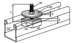
**Technische Daten** für Hammerkopfschraube HHK 41
