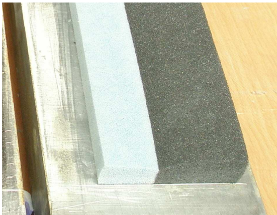
Bild 4 Foto des ausgebauten Bandes (erstellt vom ift Schallschutzzentrum nach der Prüfung)
