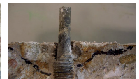
Beständigkeit des Befestigungspunktes setzt Beständigkeit von Untergrund, Befestigungselement und Verbundmörtel voraus
