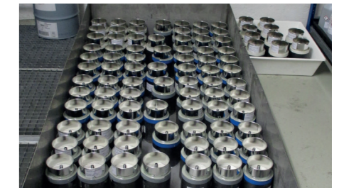
Beschichteter Beton: beispielhafter Prüfaufbau zum Nachweis der Dichtigkeit oder Beständigkeit
